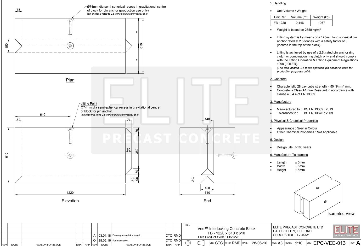
N:\Drawings\AutoCAD Files\ICB - Vee\EPC-VEE-013\_A - 1220 x 610 x 610 (FB-1220).dwg
